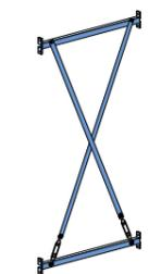
Für Stabilität in Längsrichtung sorgen die **Ständerverbindungen** und **Diagonalverbände**. Bis 5.000 mm Ständerhöhe sind zwei Ständerverbindungen je Feld nötig, ab 5.001 mm sind drei Ständerverbindungen nötig. Diagonalverbände sind mindestens in jedem fünften Feld erforderlich.
